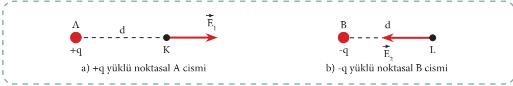
Görsel 2: Yüklü noktasal cisimlerin kendilerinde d kadar uzaklıktaki bir noktada meydana getirdiği elektrik alanının yönü
